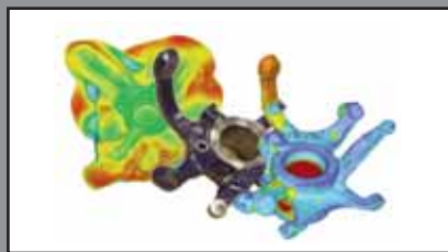
Simulazione stampaggio a caldo fuso a snodo
