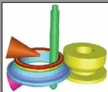
Simulazione processo di Ring-rolling
