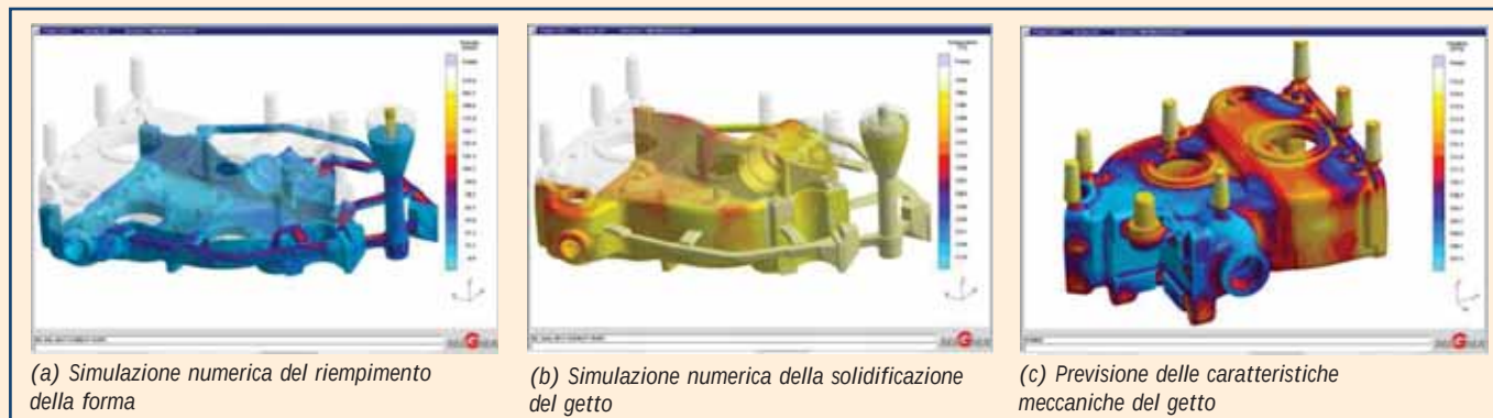
Figura 3: Il software di simulazione termofluidodinamica MAGMA
