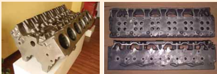
Figura 2: Due esempi di prodotti SCM (basamento motore 12 cil a V e testa motore 6 cil linea)
