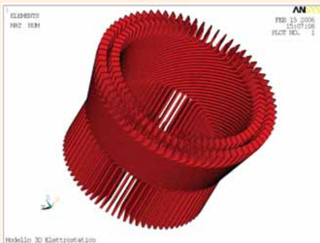
Fig 12: Testata turboalternatore: barre di rame Fig 12: Turbo alternator head: copper bars
