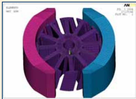
Fig 9: Motore a magneti permanenti: mesh del rotore e dei magneti Fig 9: Permanent magnet engine: rotor and magnets mesh
