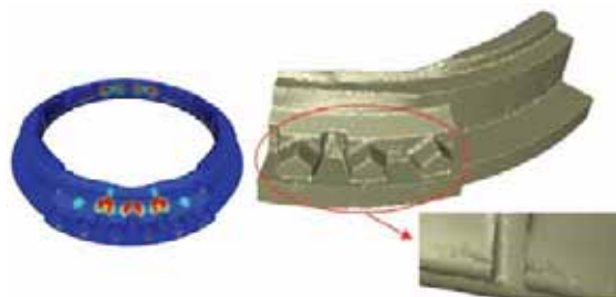
Ripieghe - il miglioramento delle funzioni di contatto consente ora di individuare con precisione dove si formano le ripieghe e di seguirne l'evoluzione
