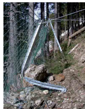
Fig. 7 - Vista dell'effetto dell'impatto di un blocco su un montante e simulazione e risultato della simulazione
