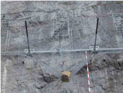
Fig. 4 - Viste del prototipo post-test installato nel campo prove di Whalenstadt (CH) e risultato della simulazione
