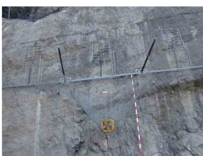
Fig. 5 - Viste del prototipo post-test installato nel campo prove di Whalenstadt (CH) e risultato della simulazione
