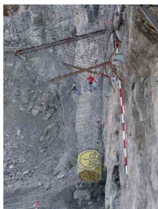
Fig. 6 - Viste del prototipo post-test installato nel campo prove di Walenstadt (CH) e risultato della simulazione
