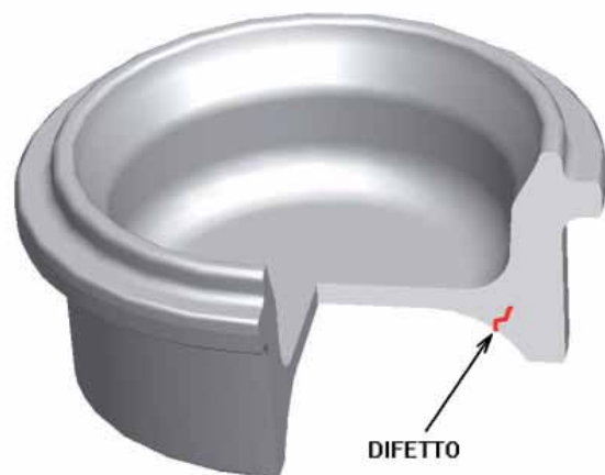
Fig.2 - corpo riduttore - posizione del difetto
