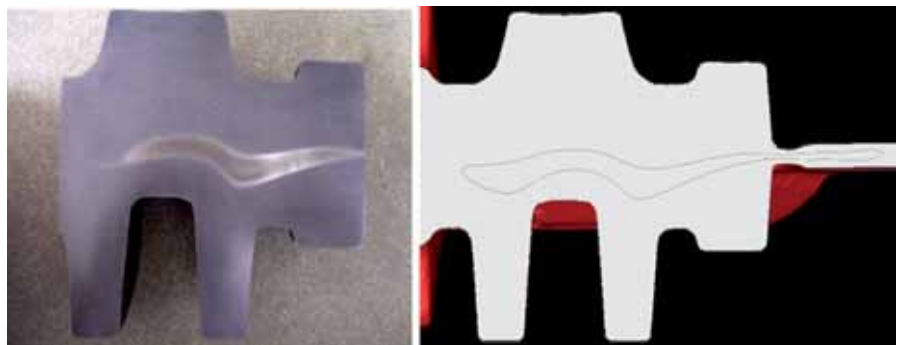
Fig. 17 – albero 8 cilindri – sezione longitudinale B nucleo – vista reale e simulazione
