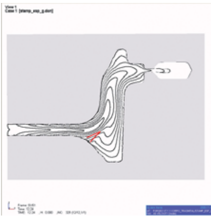
Fig.3 - corpo riduttore - fibratura del materiale
