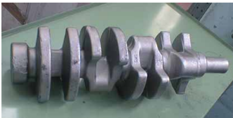
Fig.10 – albero 8 cilindri – pezzo reale dopo tranciatura
