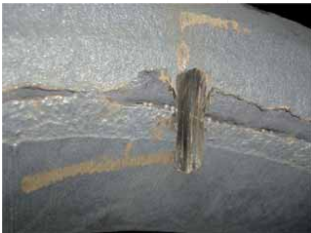
Fig. 1 - corpo riduttore - difetto nel pezzo reale
