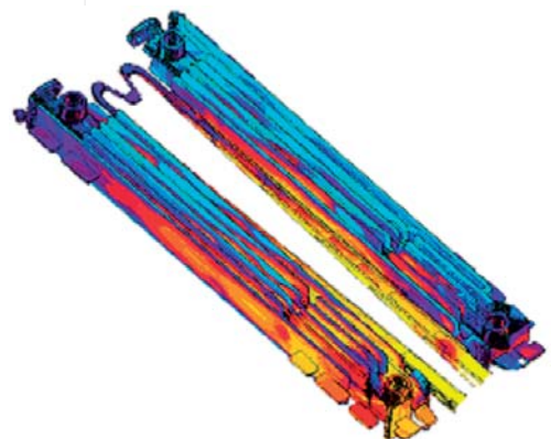
b) simulazione della pressocolata
